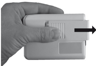
Figura 4: Apertura del vano batterie
